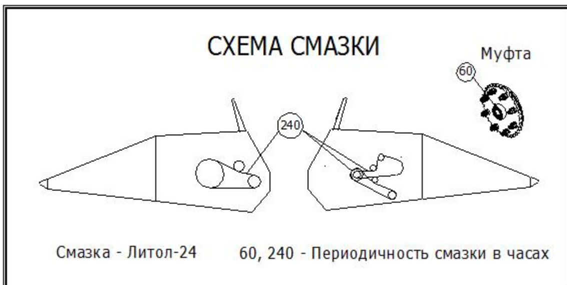
Рисунок 24. Схема смазки
